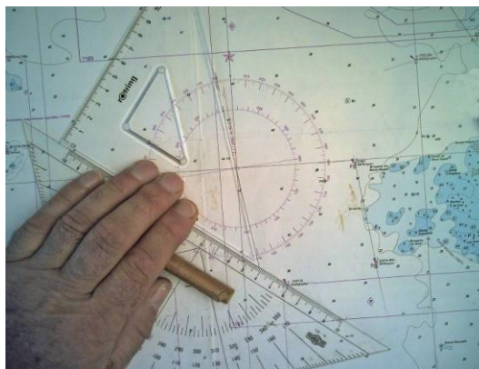
Parallelverschiebung/Kursmessung (mwK und/oder KüG)
