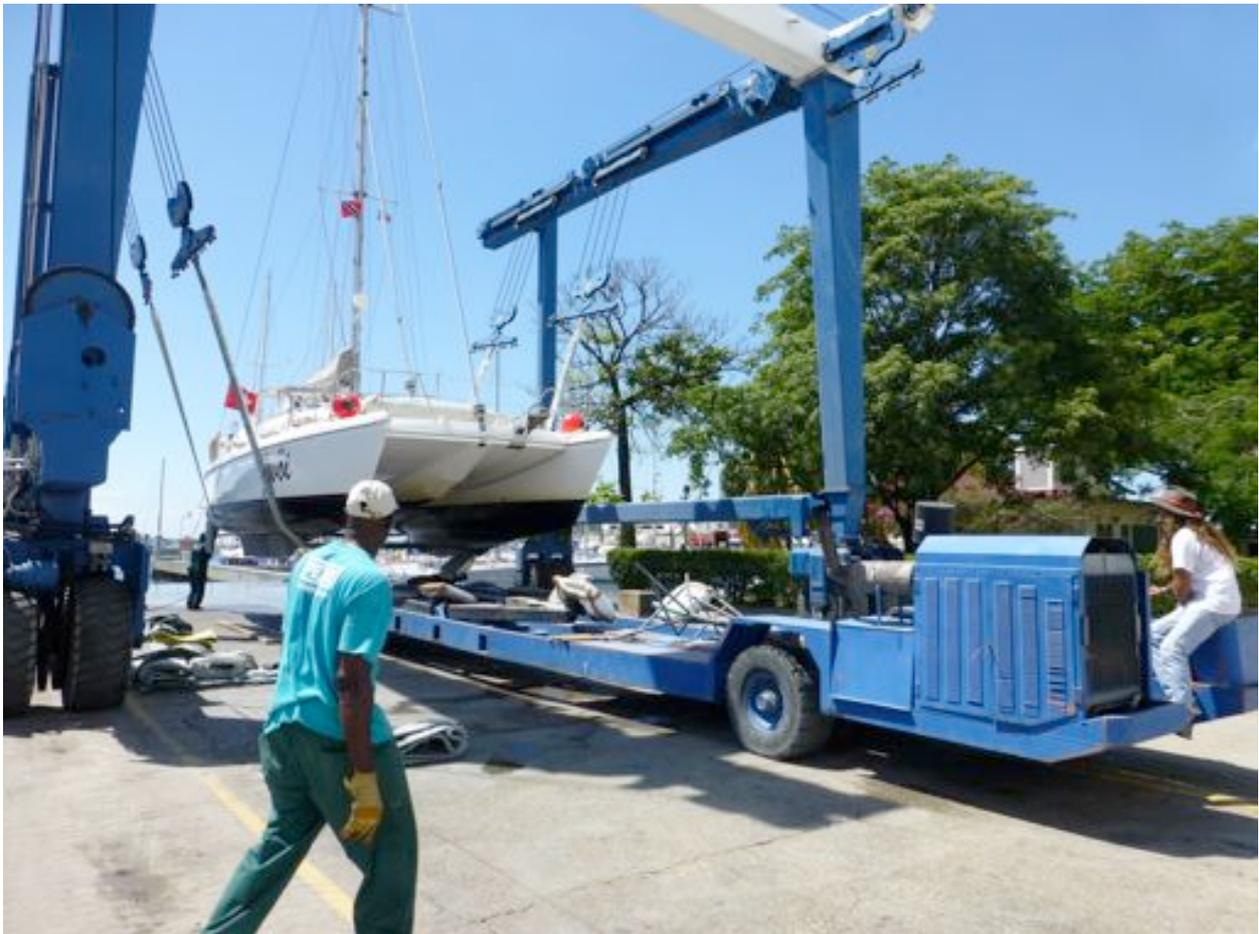
Schiff auswassern bei Peake in Chaguaramas, Trinidad
